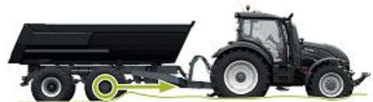
Der Benutzer kann eine Zugkraftstufe vorgeben, die selbst bei Änderung der Geschwindigkeit verwendet wird.
